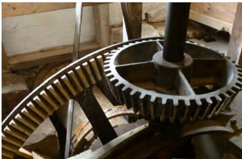
Abb. 6: Zahnradsystem in einer alten Wassermühle, ein Zahnrad aus Hainbuchenholz.
