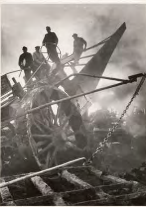
Abb. 13: Tiefpflug zum Umbruch und zum Brechen der Ortsteinschicht. (Foto: Hans Saebens, Fotoarchiv Emsland Moormuseum)
