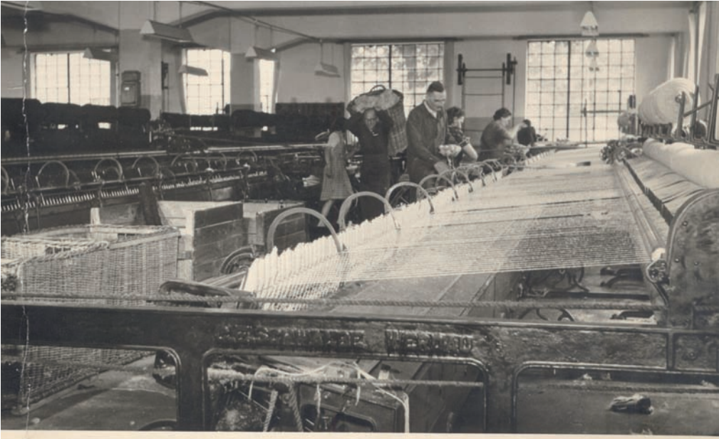
Abb. 3: Spinnerei mit Selfaktor Tuchfabrik in der Tuchfabrik von H. F. Rowedder (Foto: Griese)
