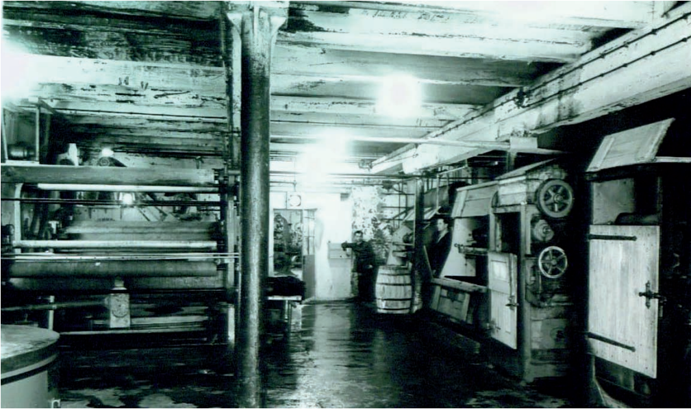
Abb. 8 Nassappretur mit Wasch- und Walkmaschinen in der Tuchfabrik von W. Wolf (Foto: Hoppe)
