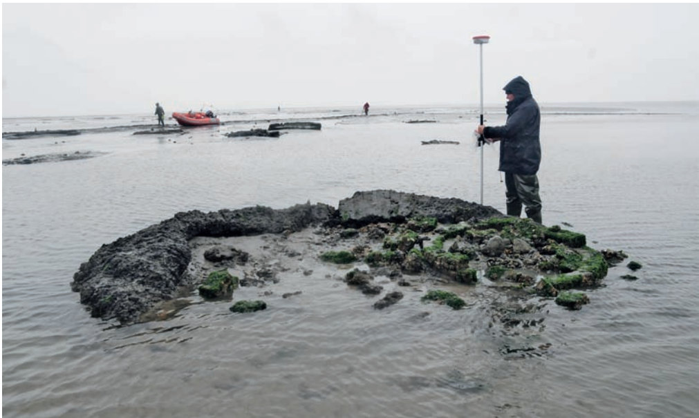
Abb. 5: Die modernen, satellitengestützten Vermessungsgeräte oder die seit diesem Jahr genutzte Drohne vereinfachen und beschleunigen die Feldarbeit. Ein s. g. Sapos ermöglicht die zentimetergenaue Dokumentation von archäologischen Funden und Fundstellen. Es wurde beispielsweise bei der Dokumentation eines der in Abb. 1 zu sehenden frühneuzeitlichen Sodenbrunnen eingesetzt.
